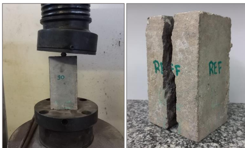
Figura 35 - Esquemática do corpo de prova prismático rompido por tração na compressão. Fonte: AUTOR (2022).
