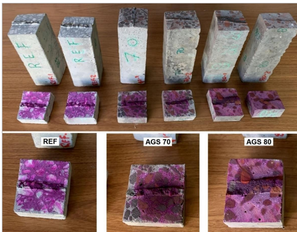
Figura 49 - Visualização da diferença de carbonatação nas faces dos prismas seccionados, aos 42 dias de ensaio. Fonte: AUTOR (2022).
