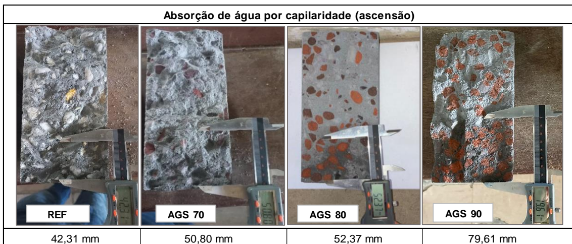
Figura 46 - Média da ascensão de água nos corpos de prova cilíndricos, rompidos diametralmente após o término do ensaio de absorção por capilaridade.
